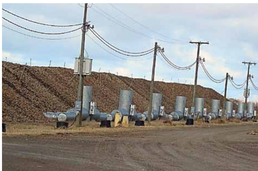
Rys. 1. Tak wygląda przyzma z burakami. Aby szybko schłodzić taką masę korzeni, przyzma jest napowietrzana specjalnymi wentylatorami po nadejściu mrozów
